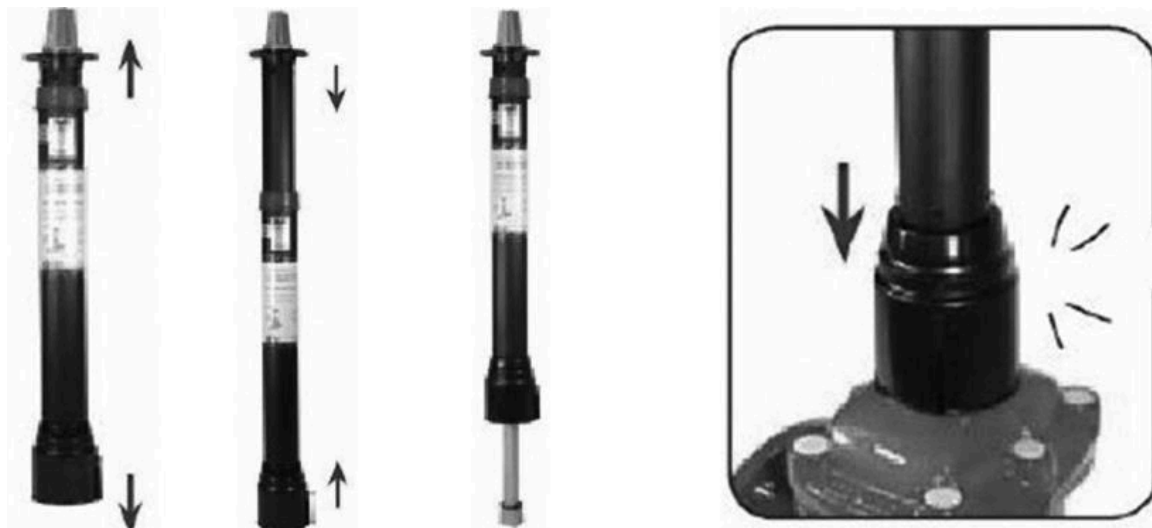
Рис. 4 Порядок установки телескопического штока на задвижку.
