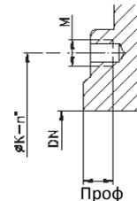
Рис. 25 • Несквозные резьбовые отверстия
