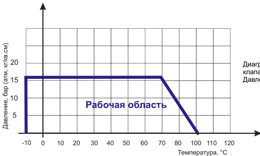
Диаграмма Давление / Температура для клапана обратного ABRA-D-022S-NBR
