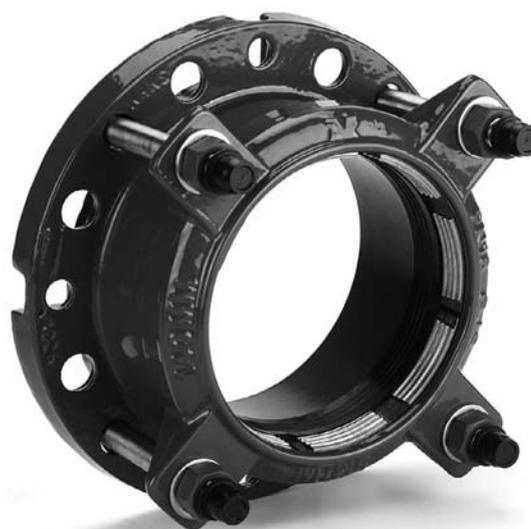
С устойчивым к натяжению уплотнительным кольцом для ПЭ труб и труб из твердого ПВХ по ISO 161 и ISO 3607. Отверстия по ISO 7005-2 (EN 1092-2: 1997, DIN 2501), PN 10 или PN 16. Для ПЭ труб качества 100 – PN 6.3, PN 10 и PN 16 и PE 80 - PN 6.3 и PN 10 по DIN 8074. Для труб Sigma 100 PN 6 и PN 10. Sigma 125 – PN 7.5 и PN 10.
